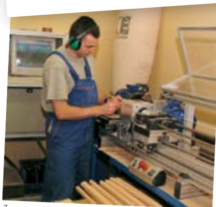
Za pomocą komputerowo sterowanych obrabiarek szlifuje się korpusy ze 100% powtarzalnością.
